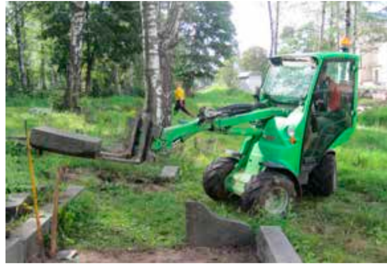
(1) Kompaktlastaren gjorde det möjligt att flytta även större grav- och kantstenar.
